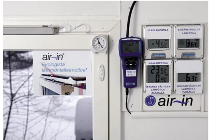
Dir-Air Oy:n laboratorion webkameran kautta voi seurata reaaliajassa tuloilmaikkunan ilman lämpenemistä osoitteessa www.dir-air.fi .
